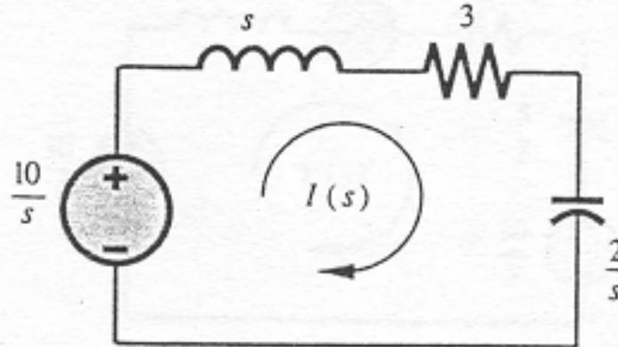
No domínio de Laplace as relações entre tensões e correntes passam a ser lineares (deixam de existir derivações).
